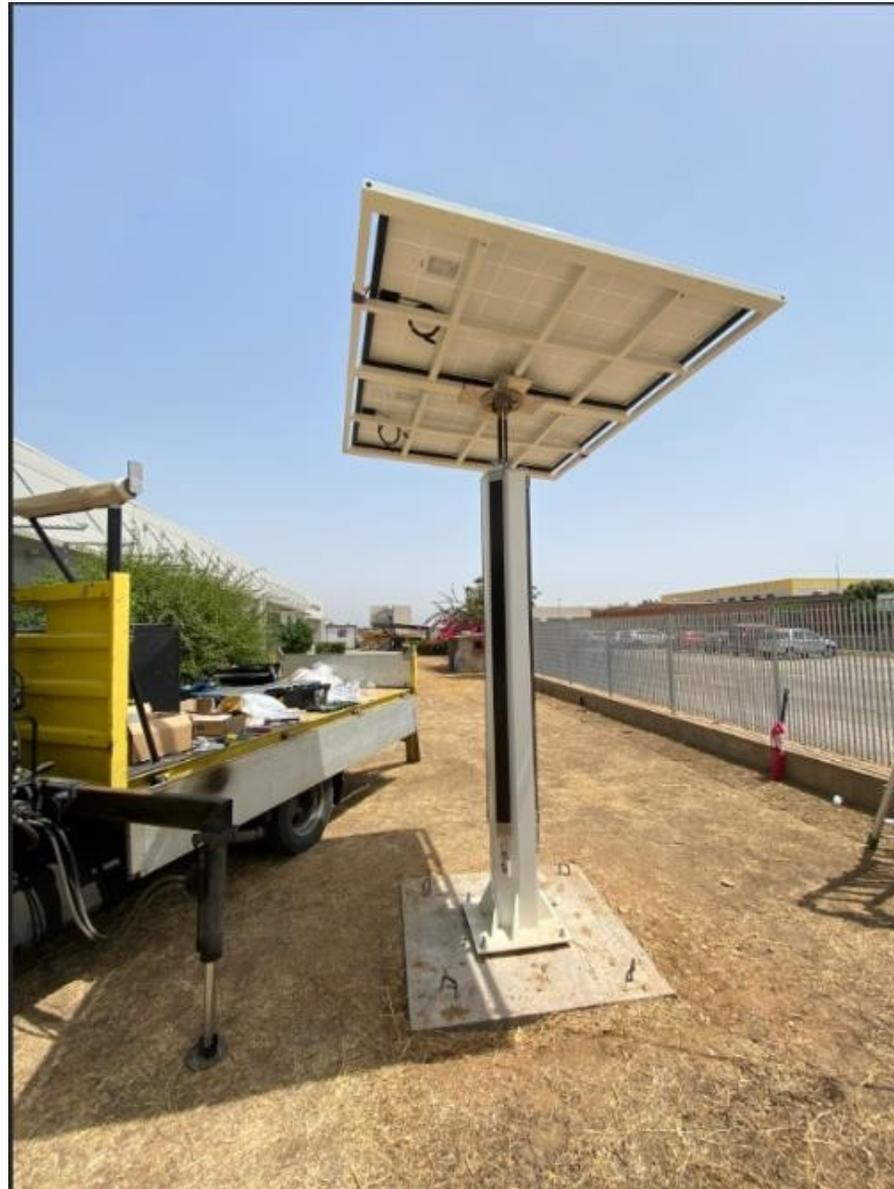
Il montaggio finale della struttura di supporto dei pannelli fotovoltaici è rimasto incompleto a causa dell'eccessivo peso dell'insieme con i pannelli stessi. Per validare comunque il progetto in termini di potenzialità di movimento tramite gli attuatori passivi congeniati, si è sostituito il tutto con un pannello di test in plexiglass
